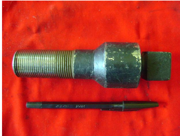
Gambar 2. Bentuk baut Diafragma Raw Mill PT. Semen Padang
