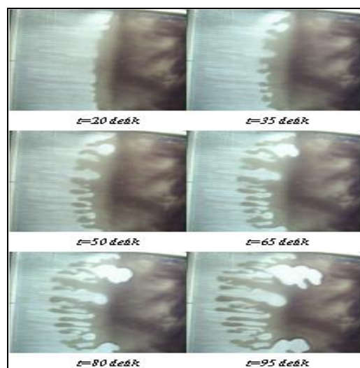
Gambar 3. Pembentukan "fingering" pada instabilitas antarmuka ( b = 0,8 mm; \alpha = 15^\circ ; arah aliran dari kanan ke kiri)
