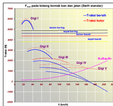
Gambar 5. F_{max} pada bidang kontak ban dan jalan kendaraan transmisi standard.
