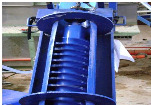
Gambar 3.2 Foto Prototipe Turbin ulir
