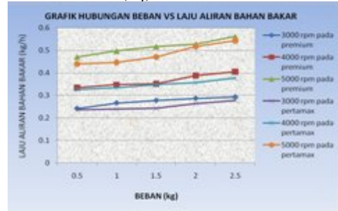
Gambar 3. Grafik hubungan antara Beban ( m ) terhadap Laju aliran bahan bakar ( m_f )
