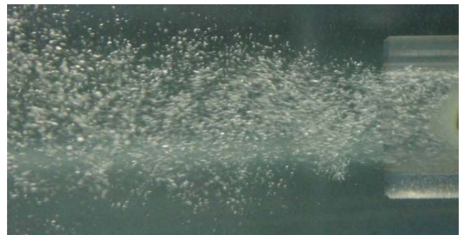
Gambar 8. Intensitas bubble saat posisi aksial bola tepat berada di tengah
