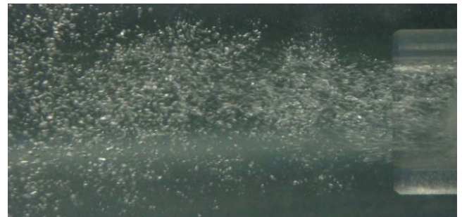
Gambar 7. Intensitas bubble saat posisi aksial bola dimajukan 2 mm
