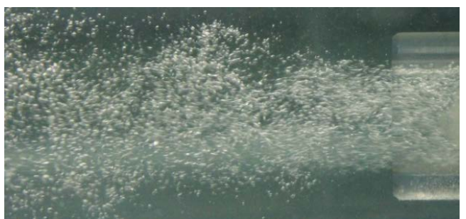
Gambar 9. Intensitas bubble saat posisi aksial bola dimundurkan 2 mm
