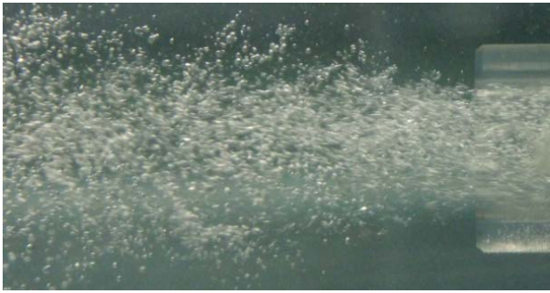
Gambar 10. Intensitas bubble saat posisi aksial bola dimundurkan 4 mm
