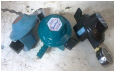
Gambar1. Beberapa contoh regulator yang dilengkapi bola gotri pada bagian keluarannya.
