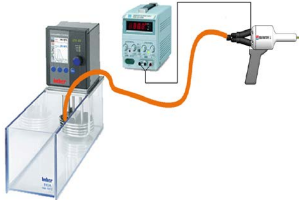
Gambar 2 Skematik pengujian termoelektrik cryosurgery
