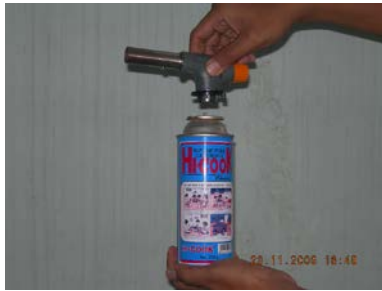
Gambar 10: Cara menggunakan alat las/solder pada tabung gas
