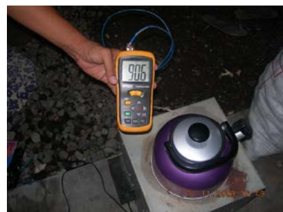
Gambar 14: pengukuran temperatur saat mendidihkan air
