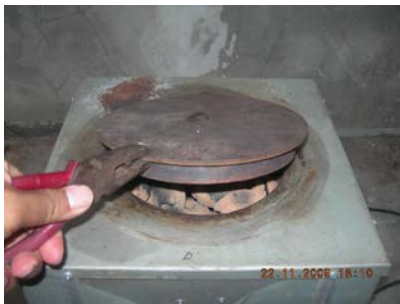
Gambar 15: cara mematikan api dengan menutup dengan plat besi
