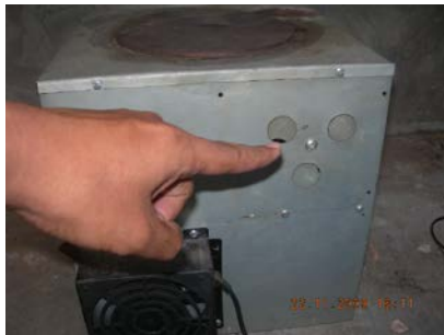
Gbr 16: cara mematikan api dengan menutup saluran udara masuk
