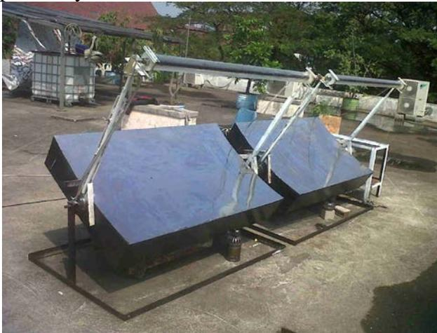
**Gambar 2.** Konsentrator parabolik di atas Gedung Engineering Center
