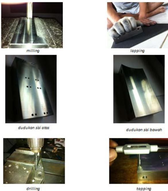
Gambar 14. Proses pemesinan pada pembuatan dudukan modul TEG
