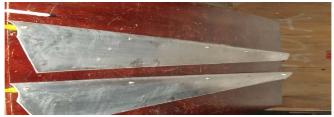
Gambar 2. Sudu-sudu propeler dua meter yang terbuat dari pelat Aluminium dengan profil korda airfoil NACA 4412
