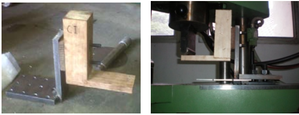
Gambar 7. Jig yang digunakan untuk pengujian momen.
