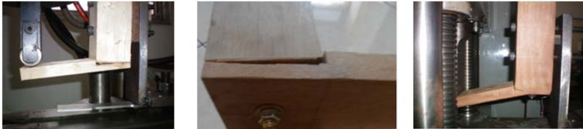
Gambar 16. Kondisi kegagalan pada jenis-jenis sambungan tegak lurus: a. Sambungan lem, b. Sambungan lem + 1 baut, c. Sambungan lem + 2 baut.
