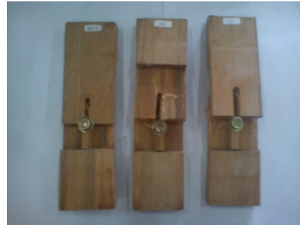
Gambar 14. Kegagalan kayu pada sambungan baut akibat beban tarik.
