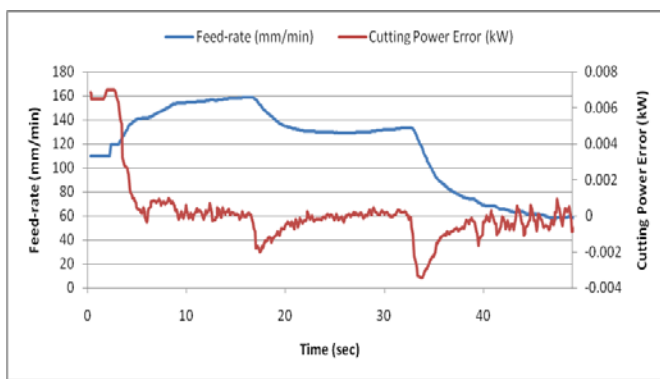
Gambar 5. Respon kecepatan makan untuk pemesinan aluminium pada rpm 2000
