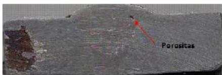
Gambar 9, cacat porositas
