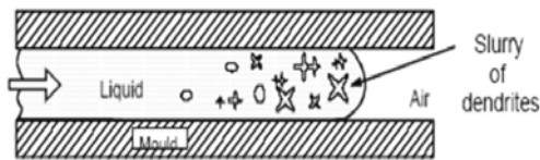
Gambar 1.2 Mekanisme solidifikasi pada paduan dengan rang pembekuan panjang (TALAT 2006)
