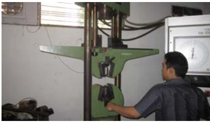
Gambar (8) Proses uji tarik sedang dilakukan dengan menggunakan mesin uji tarik di Laboratorium FTMB ITB
