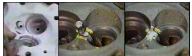
Gambar 10. Perbaikan cacat permukaan pada cylinder head dengan metode metallock
