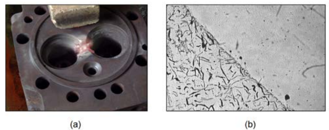
Gambar 6. Hasil perbaikan dengan metode powder flame spray dan Struktur mikro di fusion line . Logam pengisi : serbuk nikel.
