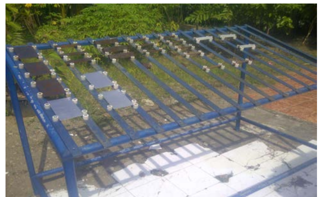
Gambar 3. Ekspos spesimen uji pada rak pengujian
