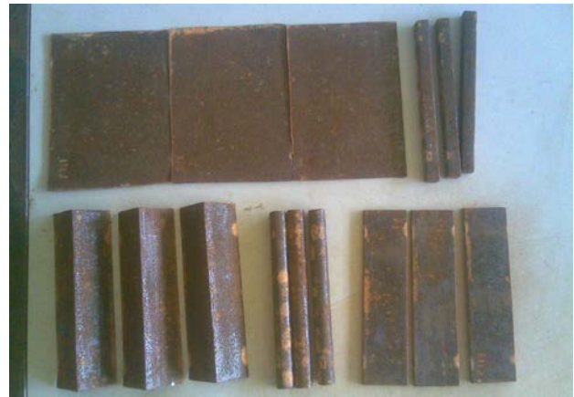
Gambar 2. Bentuk dan jenis spesimen uji
