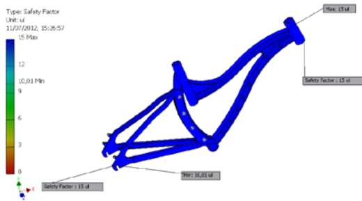
Gambar 3.4.. Safety factor pada frame rancangan awal ketika digunakan dalam kondisi sitting pedal
