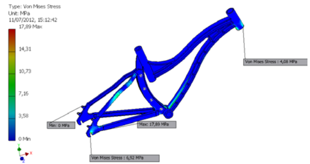
Gambar 3.2. Tegangan yang dialami frame rancangan awal ketika digunakan dalam kondisi sitting pedal.
