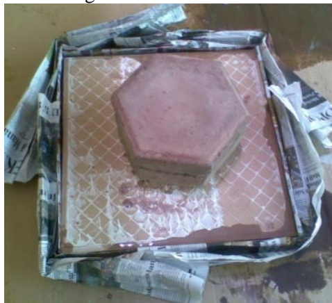
Gambar 4. Cetakan untuk produksi material komposit.
