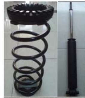
Gambar 5. Sistem suspensi : pegas dan shock absorber
