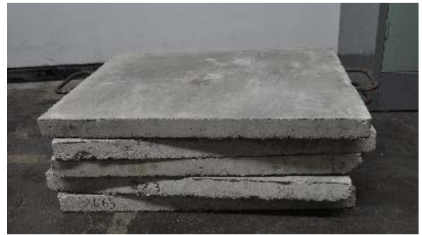
Gambar 4. Massa uji balok beton
