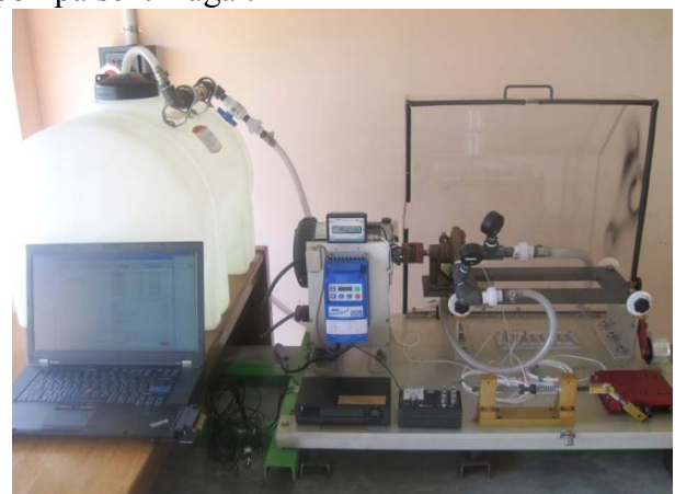
Gambar 5 Instalasi eksperimen pompa sentrifugal.
