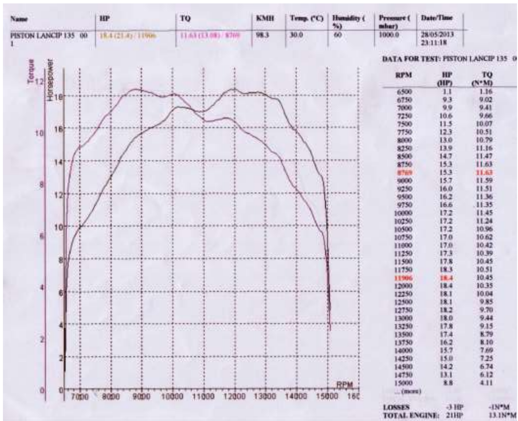
Gambar 2. Torsi dan daya yang dihasilkan mesin dengan piston datar
