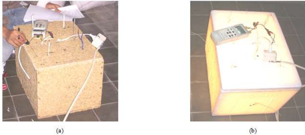
Gambar 3. Pengukuran temperatur untuk menentukan konduktivitas termal pada (a) kotak dari papan partikel sekam padi (b) kotak gabus
