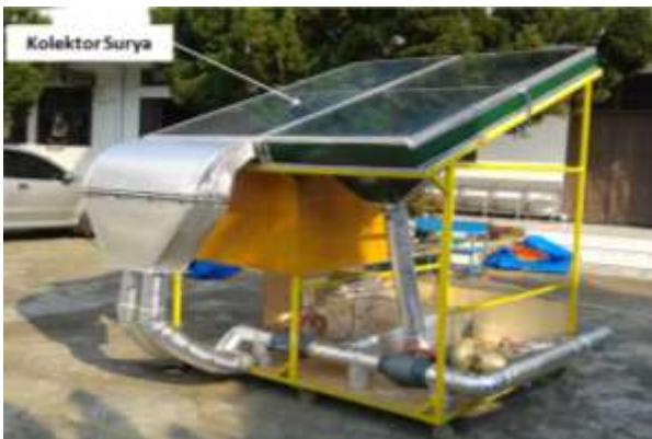
Gambar 1. Photo sistem kolektor surya
