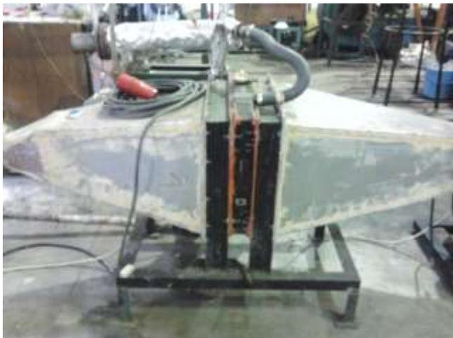
**Gambar 3.** Saluran sistem penukar panas udara pengering setelah dimodifikasi.
