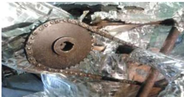
**Gambar 6.** Transmisi penggerak katup putar yang diganti dengan rantai dan sproket.
