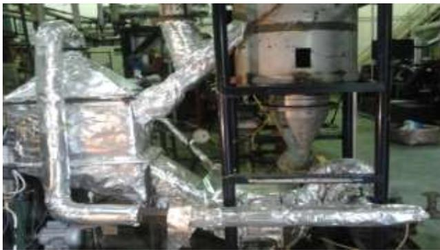
**Gambar 5.** Instalasi saluran gas torefaksi hasil modifikasi.
