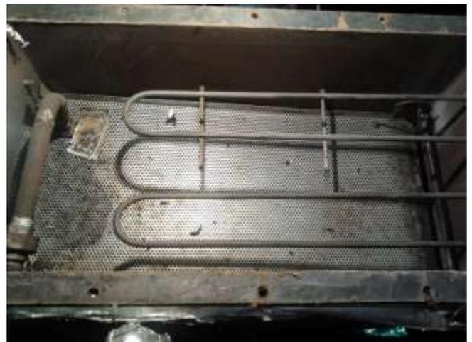
**Gambar 4.** Posisi pelat distributor dan pemanas listrik pada unggun torefaksi setelah dimodifikasi.
