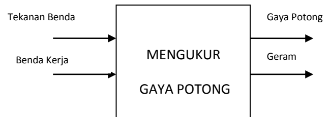
Gambar 2. Black box fungsi dynamometer .
