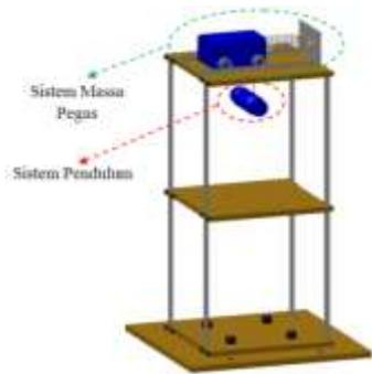
Gambar 1 Model struktur bangunan dengan peredam dinamik ganda
