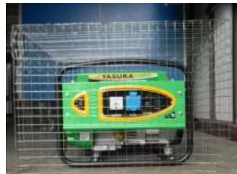
Gambar 7 pemasangan sangkar untuk koordinat pengukuran
