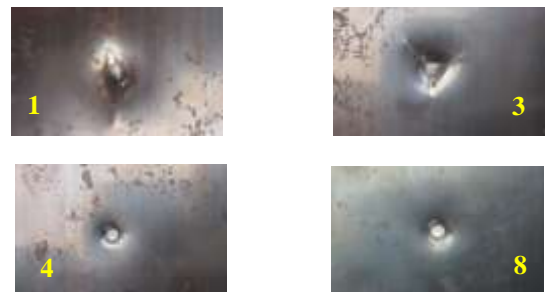
Gambar 5. Bagian depan material target setelah ditembus peluru pada percobaan 1, 3, 4 dan 8.
