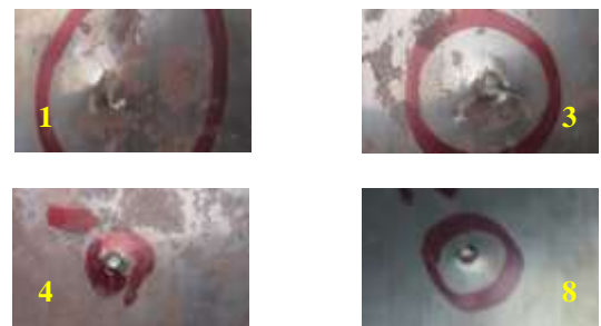
Gambar 6. Bagian belakang material target setelah ditembus peluru pada percobaan 1, 3, 4 dan 8.
