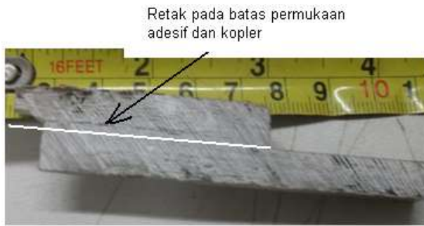
Gambar 20 Mode kegagalan spesimen p-2 yang mendapat beban tekanan internal.
