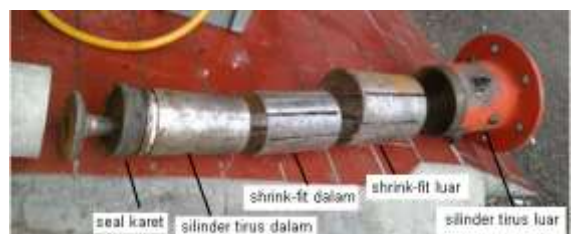
Gambar 11 Foto bagian-bagian holder
