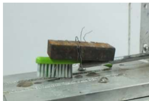
Gambar 3. Sistem penempatan sikat gigi dan pembebanan. Ujung tungkai pendorong (F), Sikat gigi (G), beban (H), Tempat sampel material gigi palsu (I)
