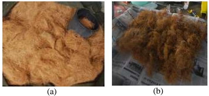
**Gambar 2.** Serat sabut kelapa (a) sebelum (b) setelah direndam air dengan 5% NaOH
