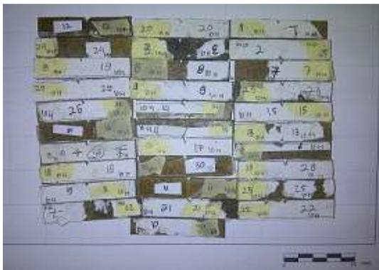
**Gambar 6.** Sampel uji impak
