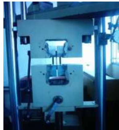
Gambar 5. Proses Uji Tarik pada mesin uji tarik Tipe PM 10 Galdabini
