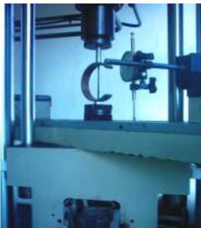
Gambar 9. Proses Pengujian Ring C pada mesin uji tarik Tipe PM 10 Galdabini
