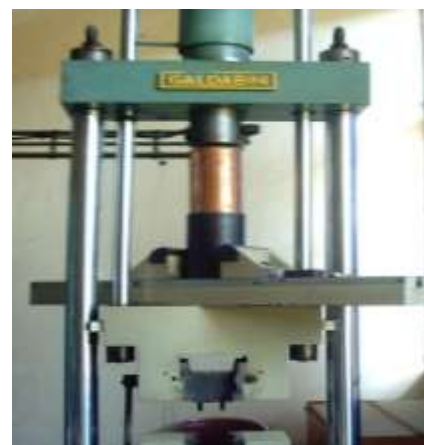
Gambar 2. Pembuatan metal cladding pada mesin uji tarik Tipe PM 10 Galdabini
