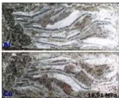
(b) struktur makro patahan AA 5052 – Cu Murni dengan menggunakan gas argon 3 ltr/mnt.
