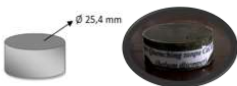
Gambar 1. Dimensi spesimen uji kekerasan dan uji struktur mikro
