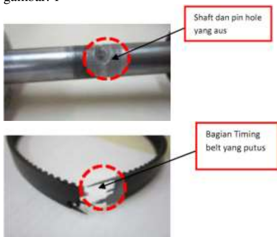
Gambar 1. Kerusakan pada Timing belt dan system hub puley
