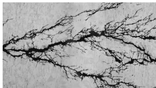
Gambar 2. Bentuk retakan pada SCC. [Sumber : PT. PIM- Aceh Lhok Seumawe].
