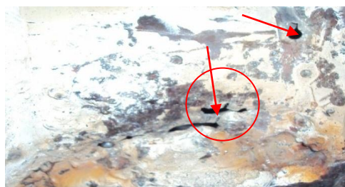
Gambar 4. Tanda anak panah menunjukkan area kegagalan pipa stainless steel.
