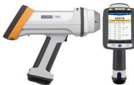
Gambar 6. Alat uji komposisi kimia X-Met. [Sumber: PT. PIM- Aceh Lhokseumawe].
