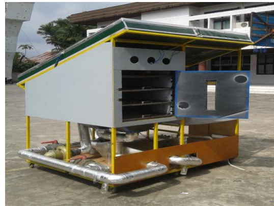
Gambar 1. Photo alat pengering pompa kalor berbantuan tenaga surya.
