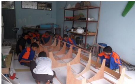
Gambar 2. Proses pembuatan cetakan sudu
