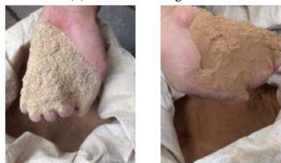
(a) (b) Gambar 2. Bahan baku yang telah dihaluskan : (a) Sekam (b) Tanah liat
