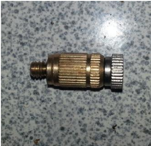
Gambar 4 Spraying nozzle yang digunakan pada dehumidifier tower .
