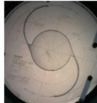
Gambar 9. Lensa Katarak, Intra Ocular Lens (IOL) dan Hasil Proses Pemesinan[13]
