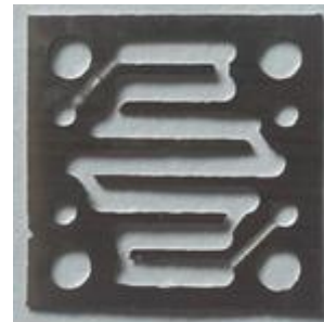
Gambar 1. Microchannel yang dibuat dengan metode electropolishing
