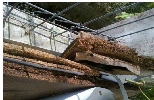
Gambar 1. Papan partikel rusak terendam air
