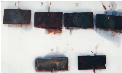
Gambar 8. Hasil uji biokorosi dari isolat bakteri dalam kondisi aerob
