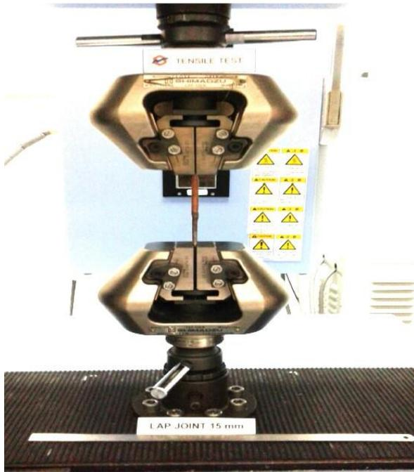
**Gambar 4.** Mesin uji tarik SHIMADZU AGS-50 kN
