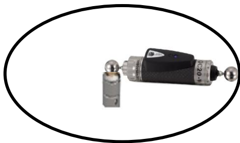
Gambar 8 Konfigurasi pengujian berdasarkan ISO 230-4 bidang XY modul 2
