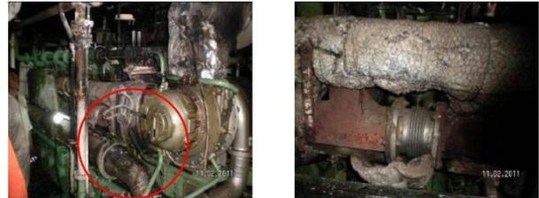
Gambar 4. Keadaan manifold gas buang mesin induk kiri pasca kebakaran
